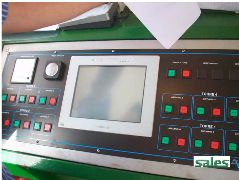
Strumentazione di bordo per il controllo elettronico della stabilità
