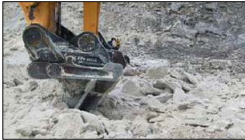
Rottura dei terreni compatti/rocciosi
